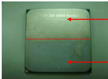
將 CPU 上舊的散熱膏清潔乾淨
