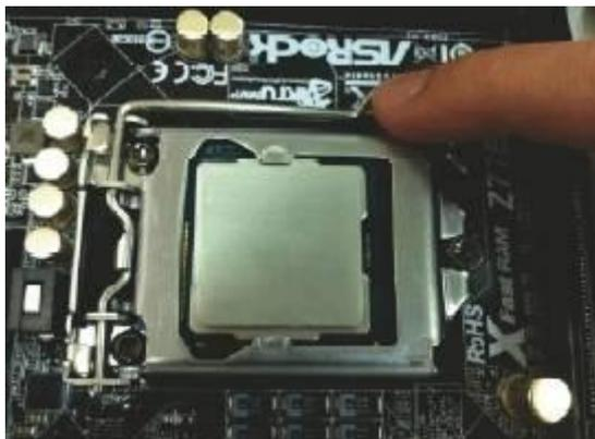
**Type B : Protection du socket insérée dans l'emplacement du processeur.**
