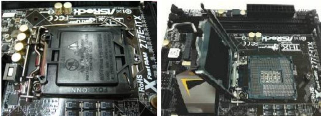
**Passo 2. Insira a CPU 1155-Pinos:** Certifique-se de localizar o Pino1 e os dois pontos de orientação, então coloque a CPU no soquete com cuidado.
