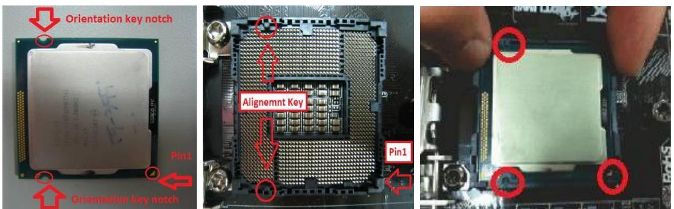
**Passo 4. Feche o soquete:** Abaixe a alavanca de carregamento, e trave com a base de carregamento sob a aba de retenção.
