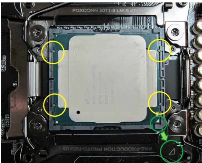
**Pasul 3. Închideți soket-ul:** Apăsați levierul pe ambele părți și fixați-le sub siguranță. Protecția de plastic se va desprinde singură.
