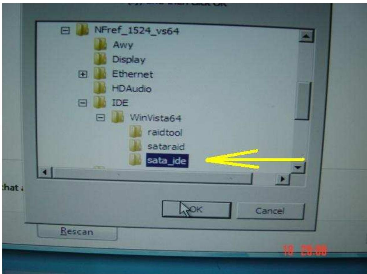
6. Sélectionnez le pilote HDD et cliquez sur "Suivant" pour procéder à son installation.
