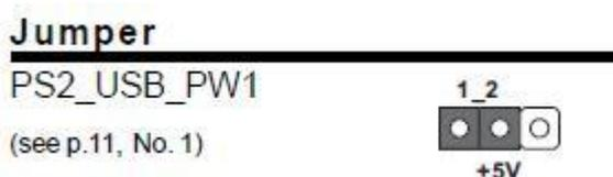
Si ce jumper n'est pas présent, veuillez paramétrer [Deep SX] sur [Enable] dans le BIOS ou régler [On/Off Play] sur [Disabled] dans le BIOS.
