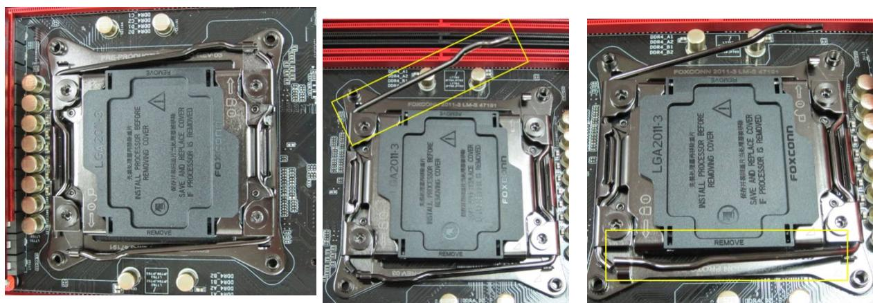
2. Вставьте процессор LGA 2011-3 CPU. Проверьте ориентацию угла Pin1 и углублений по краям процессора. Аккуратно вставьте процессор в разъём.
